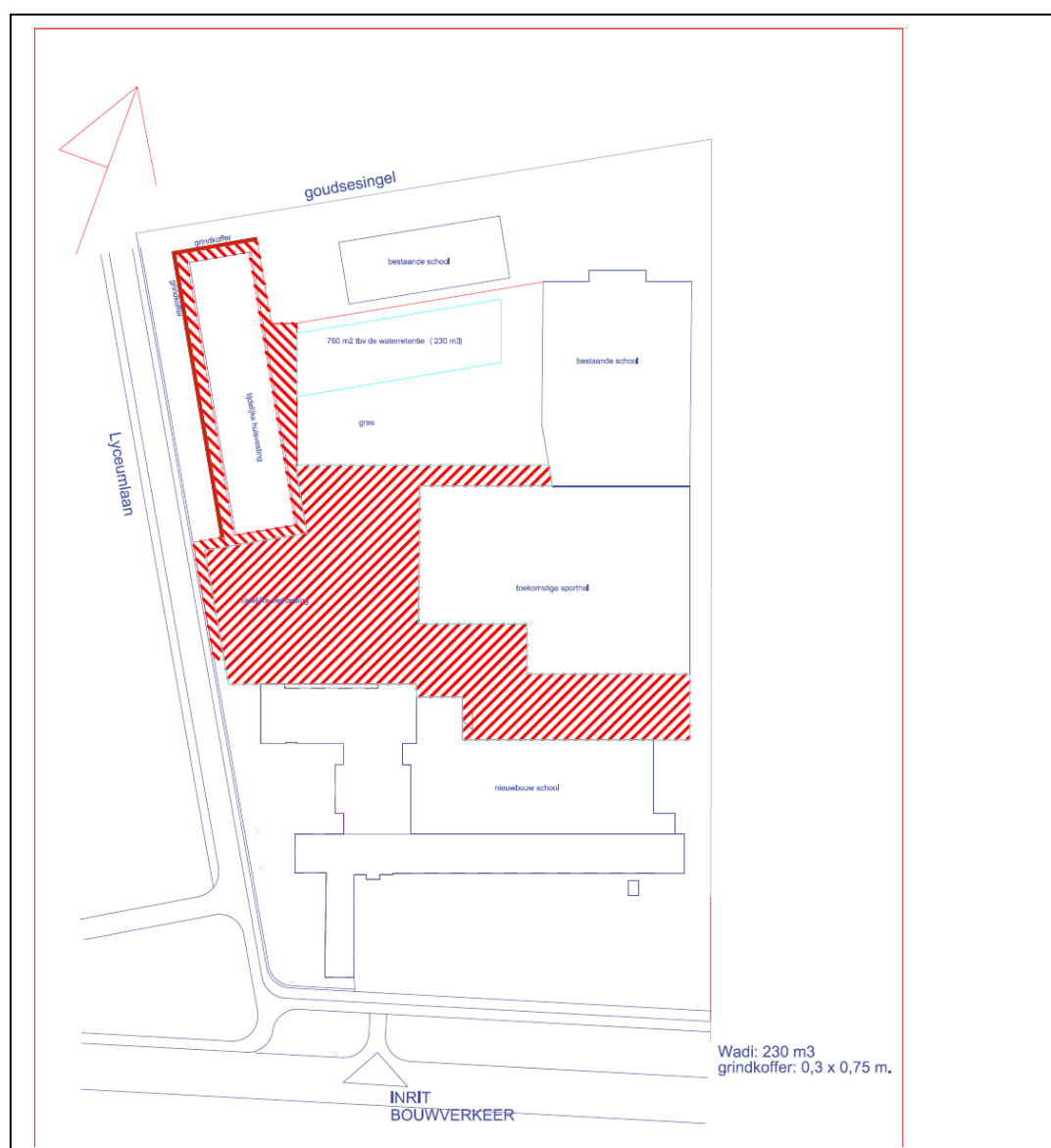
Afbeelding 2: fasering werkzaamheden, tijdelijke bebouwing is linksboven te zien. Met een rode arcering is de halfverharding van de bouwplaats aangegeven.
