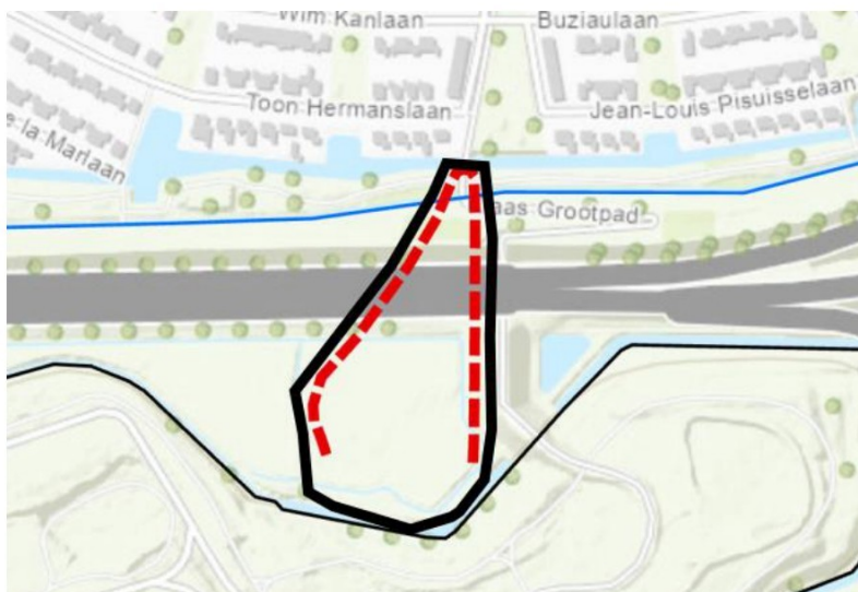
Figuur 4.1: In het zwart de damwand rond de benzeenverontreiniging
