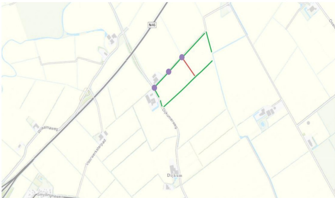
Figuur 1: Locatie van werkzaamheden. De rode lijn geeft de te dempen watergang weer. De groene lijnen geven de te verbreden watergangen weer. De paarse stippen geven de locaties weer van de al aanwezige dammen, die voorzien dienen te zijn dan wel voorzien dienen te worden van duikers.
