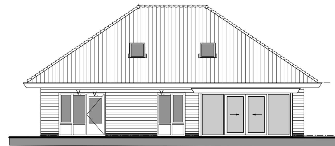
zuid gevel V = ventilatie rooster
