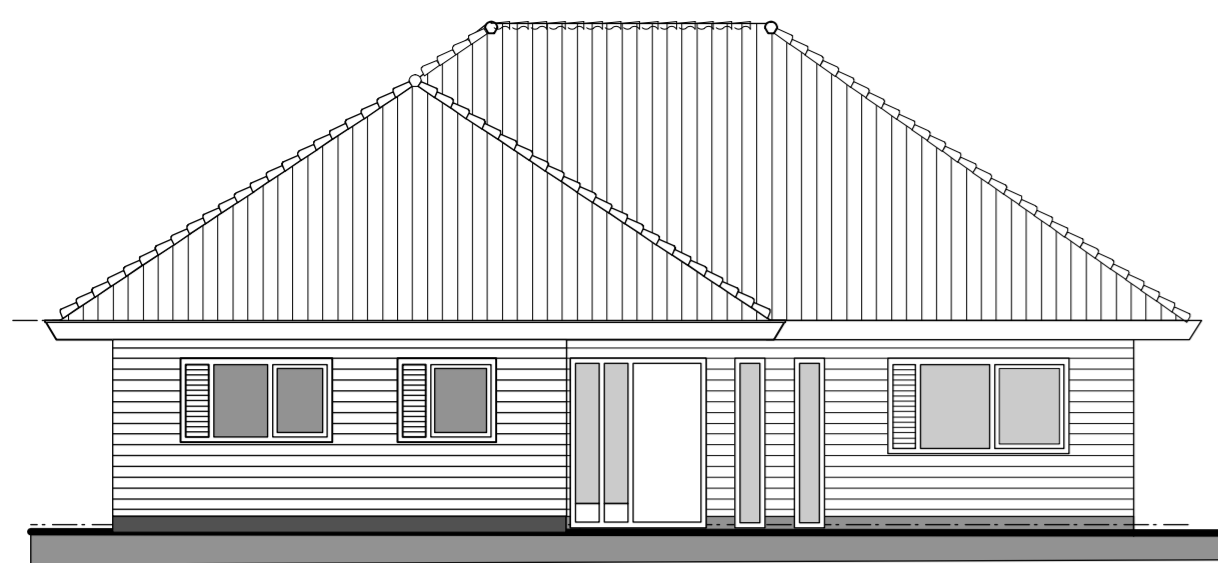
noord gevel V = bestand ventilatie rooster
