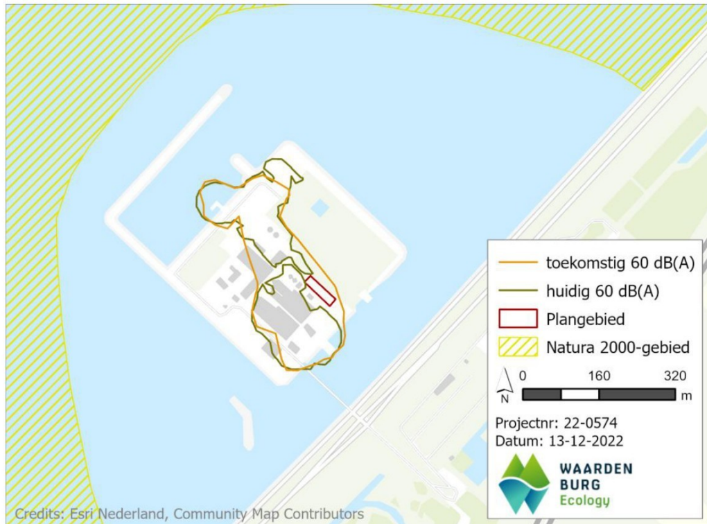
Figuur 6.3 Geluidscontouren 60 dB(A) ( L_{Ar,LT} , op 3 m. hoogte) uit 2022 voor zowel de toekomstige als de huidige situatie.
