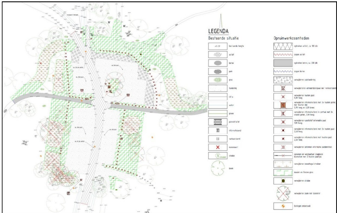
Figuur 4 Specifieke werkzaamheden herinrichting waaronder: verwijderen paaltjes en puinfundering, bosschages, bomen, stobben, graven greppel en verleggen fietspad. Bron: activiteitenplan 19 december 2025
