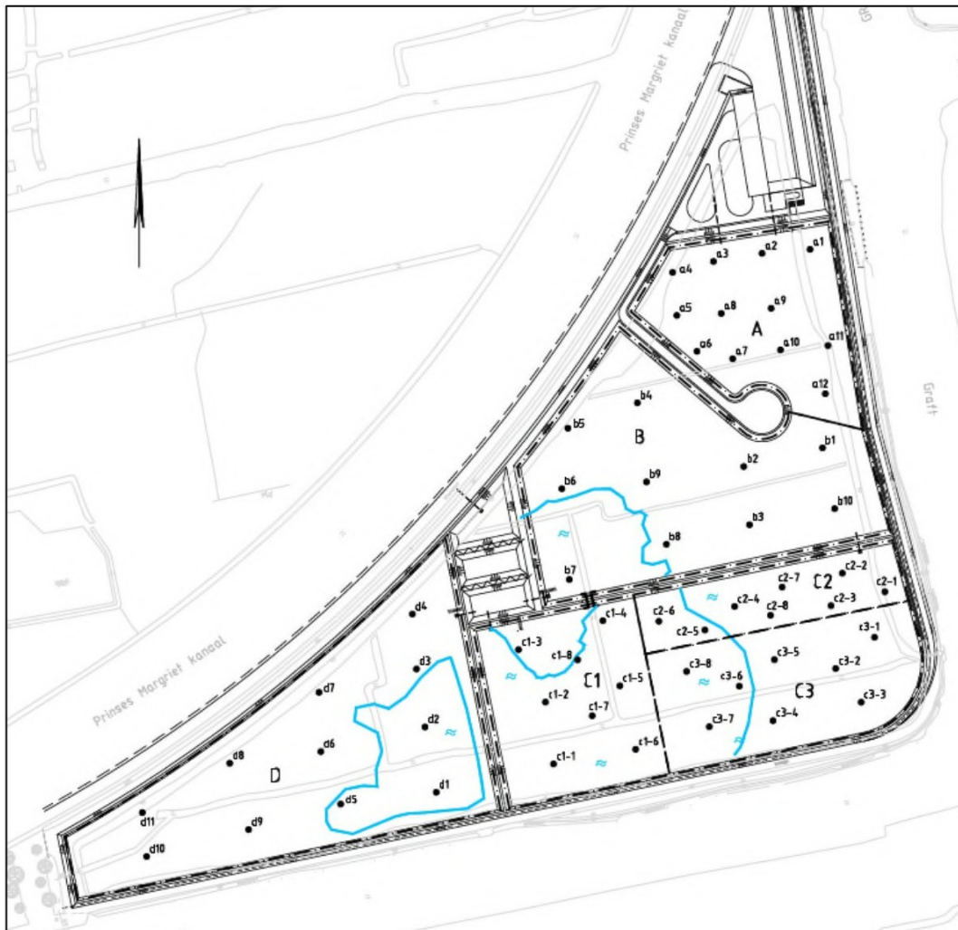
Figuur 2.1: Oorspronkelijke vakindeling baggerdepot
