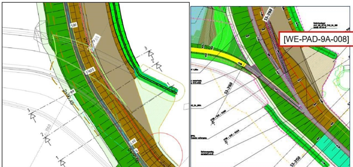
Figuur 2-14 Bovenaanzicht dijkopgang [WE-PAD-9A-008] met dwarsprofielen
