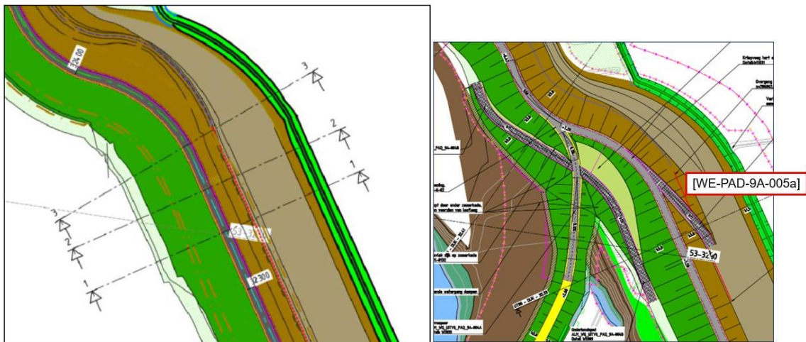
Figuur 2-36 Bovenaanzicht dijkopgang [WE-PAD-9A-005a] met dwarsprofielen
