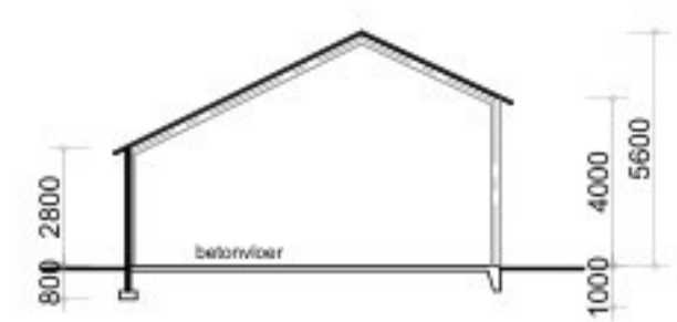
- Doorsnede A - A gebouw 1 -
