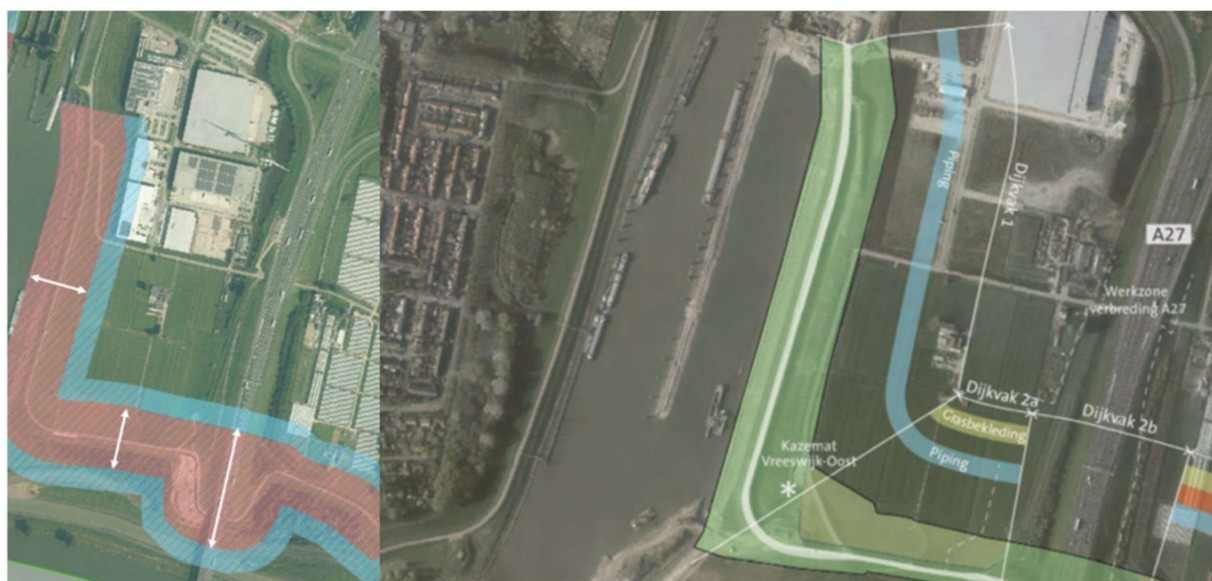
Figuur 1: Links: Huidige zonering primaire waterkering conform Waterschapsverordening HDSR[1]; rechts: versterkingsopgave op deze locatie
