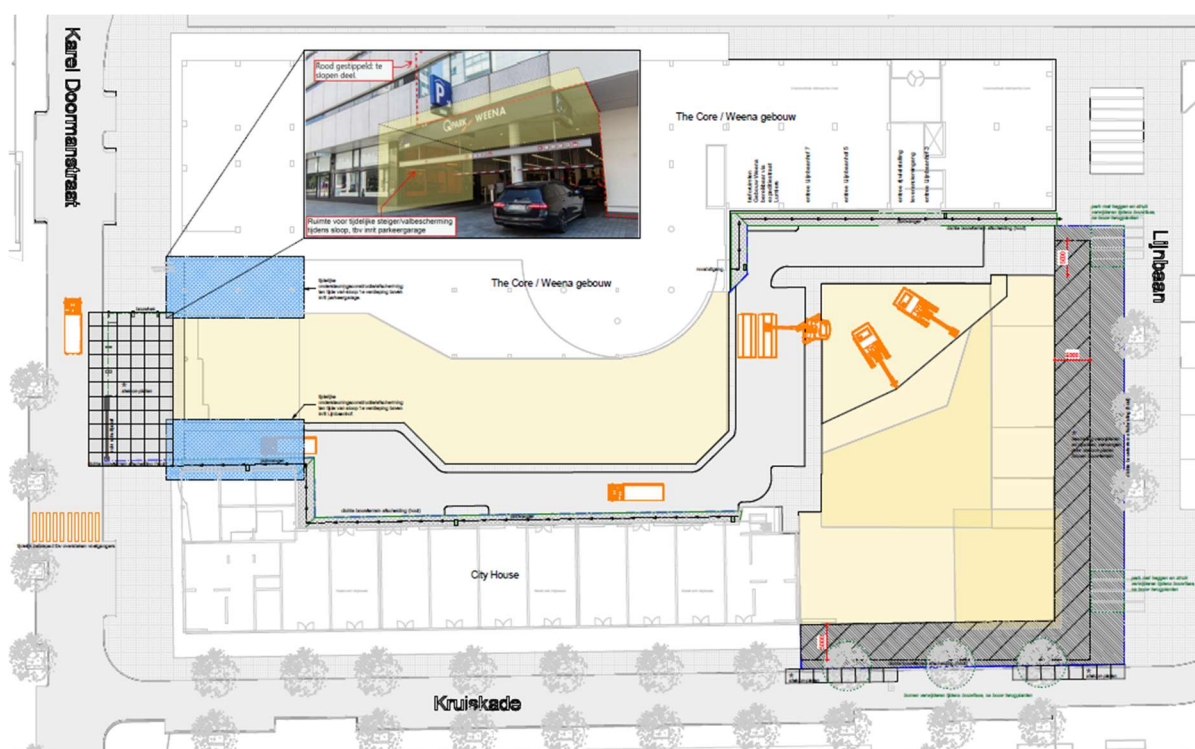
Figuur 3.2.1: bouwplaatsinrichting en fase sloop
