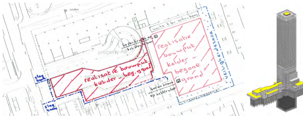
Figuur 3.1: Boven-aanzicht contouren bouwkuipen projectlocatie
