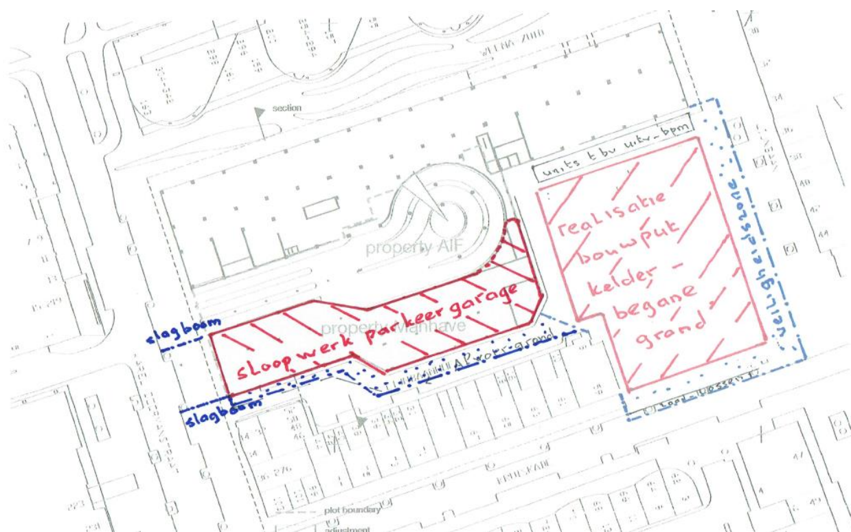
Overzicht slopen parkeergarage
