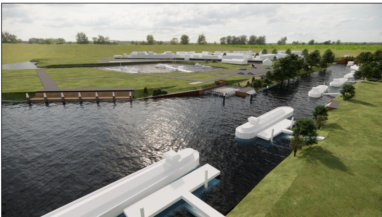
Figuur 9: Visualisatie toekomstige situatie met boven de situatie bij zeer lage rivierwaterstand en de balgstuw en gemaal in werking en onder de situatie met normaal waterpeil, waarbij de balgstuw op de bodem ligt.
