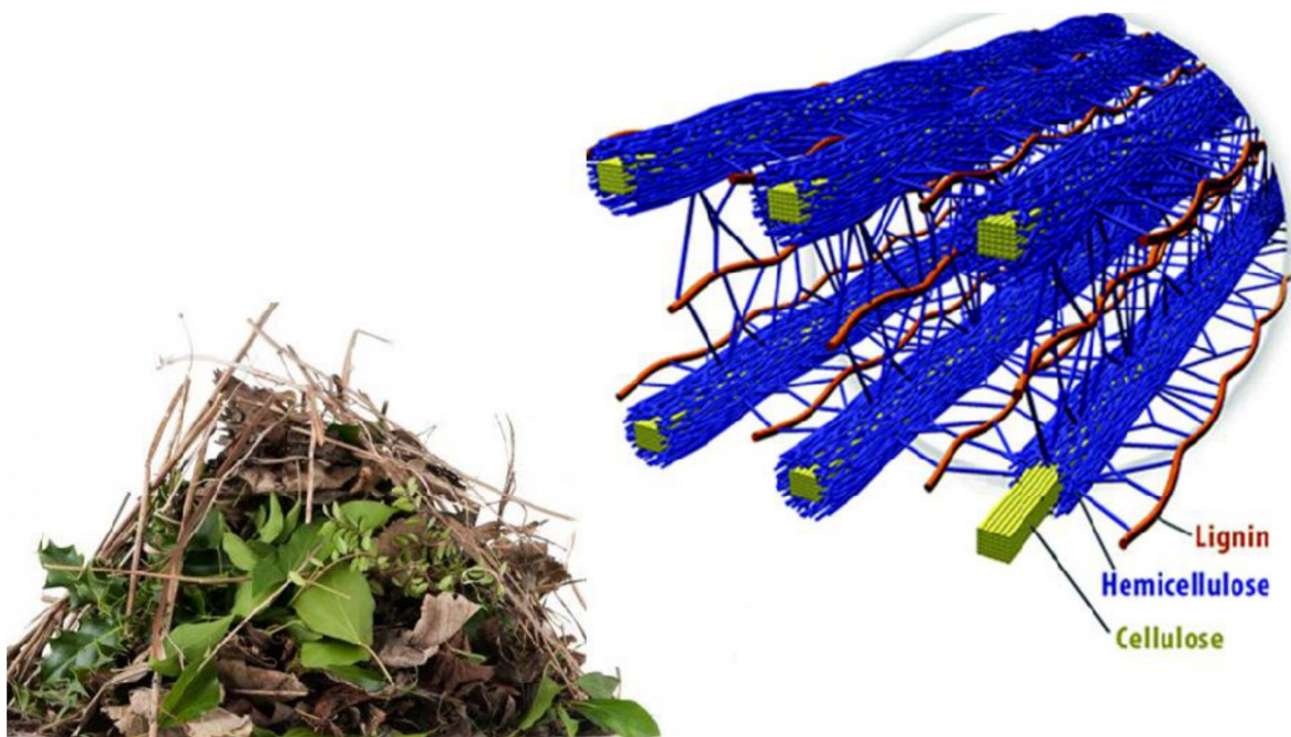
Figuur 1 Schematische weergave van de opbouw van lignocellulose, bestaande uit lignine, hemicellulose en cellulose.
