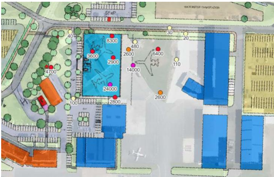
Figuur 2-4: Situering van de geplande hangar en gemeten concentraties van PFOS (ng/l) in grondwater
