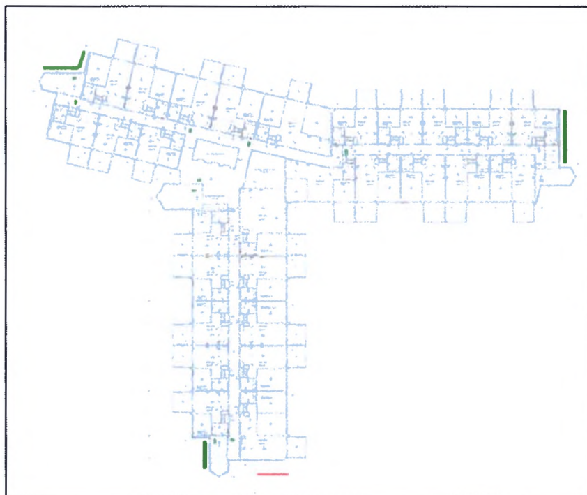
Figuur 4 Locaties gierwaluwvoorzieningen en vleermuisvoorzieningen op de blinde gevels (in groen aangegeven).
