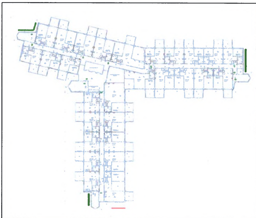
Figuur 7. Locaties gierzwaluwvoorzieningen en vleermuisvoorzieningen op de blinde gevels (in groen aangegeven).
