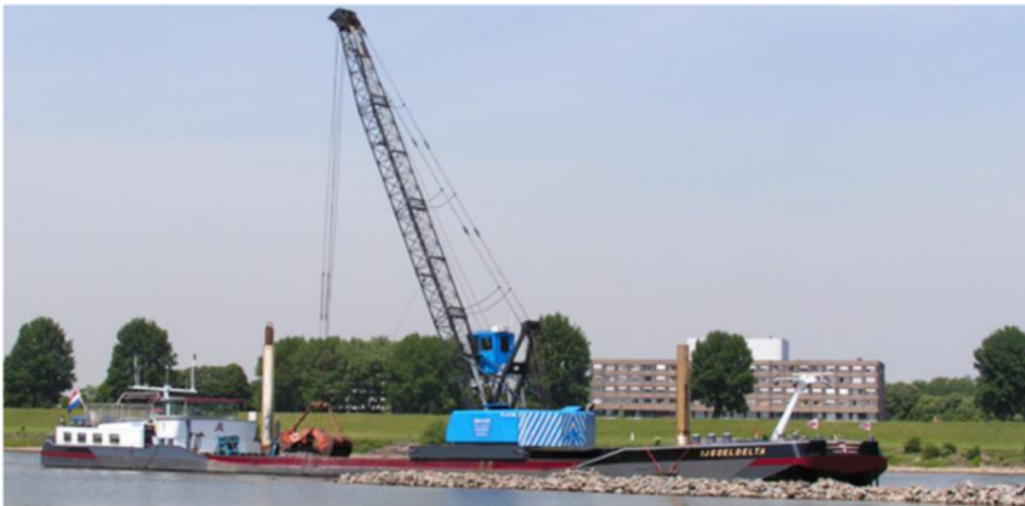
Figuur 3-3: Voorbeeld van een kraanschip met draadkraan [4]
