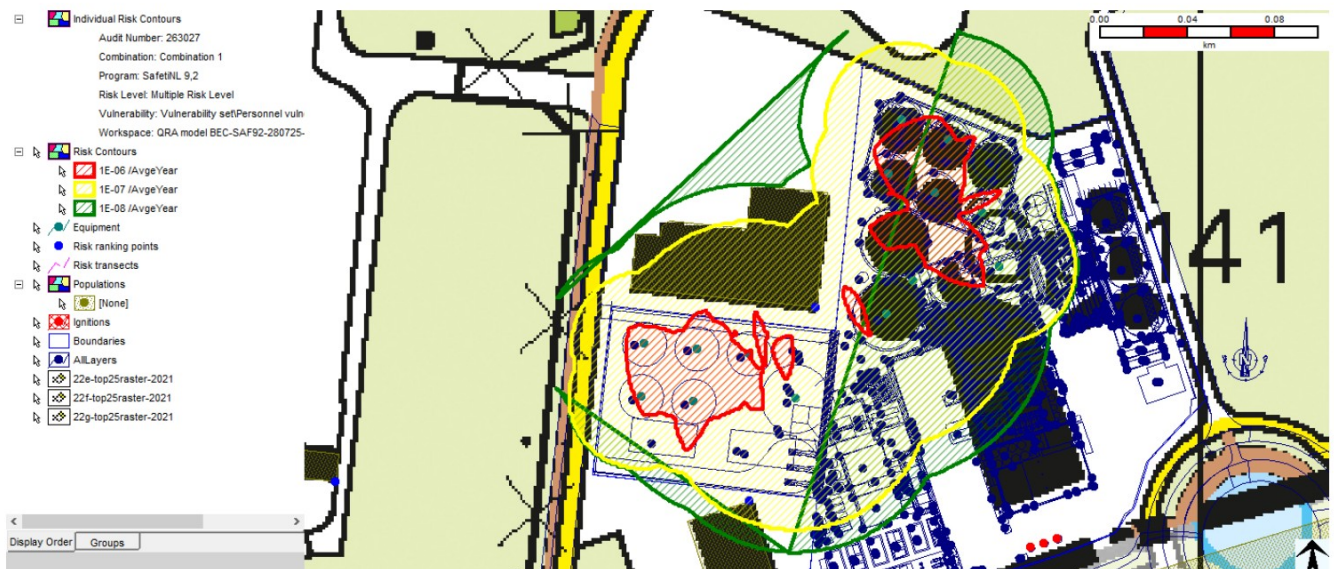
Figuur 10: Plaatsgebonden Risico-contouren in het geval snelafsluiters worden toegepast
