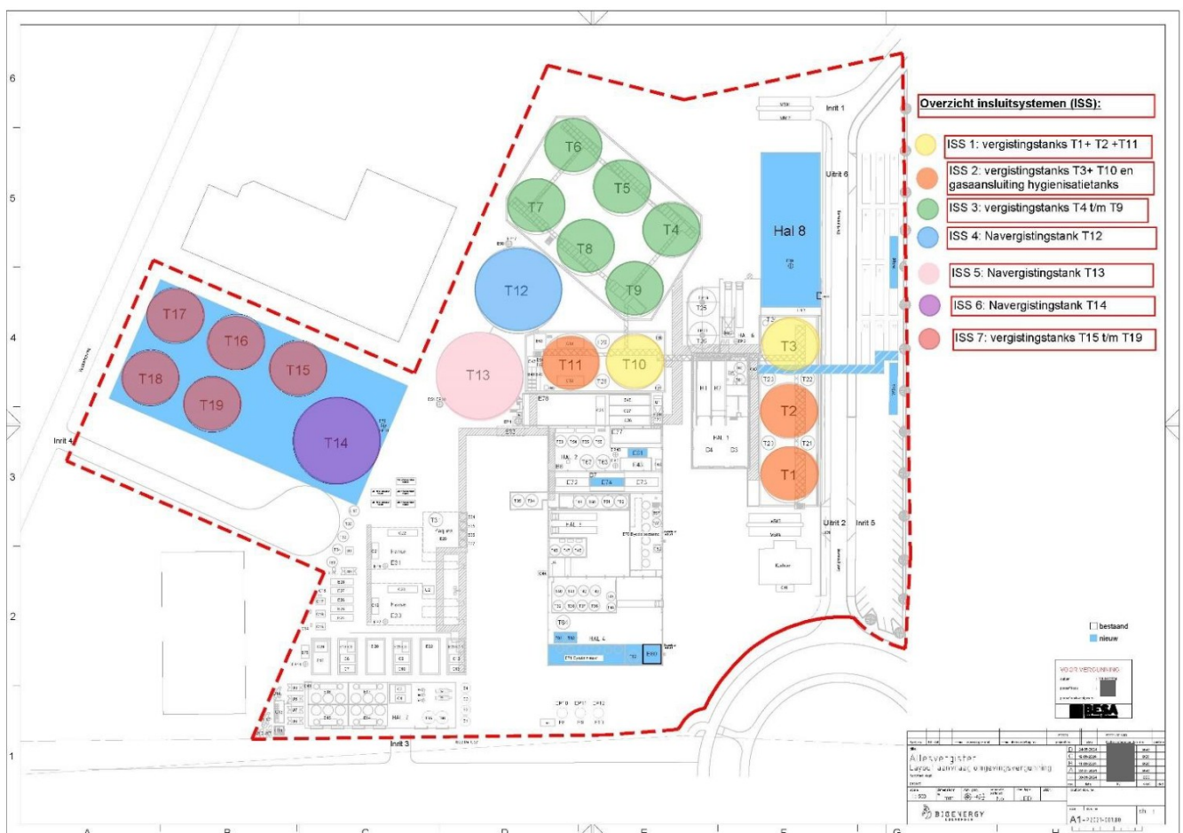
Figuur 9: Insluitsystemen na plaatsing snelafsluiters
