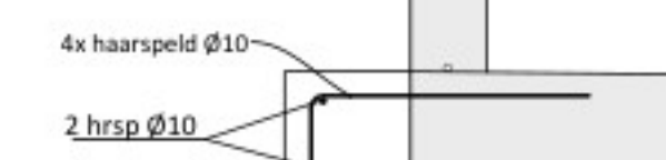
Detail 4w (tbv oplegging kolom trap) overige wapening volgens detail 2w
