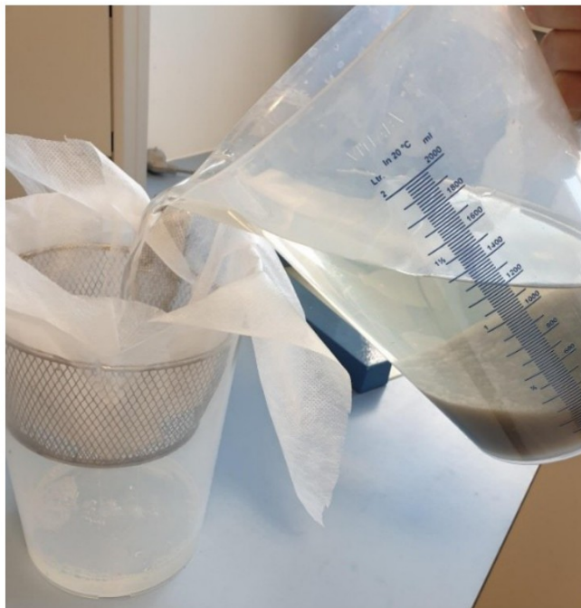
Figuur 2.6 Simulatie van het bandfilter met het filterdoek
