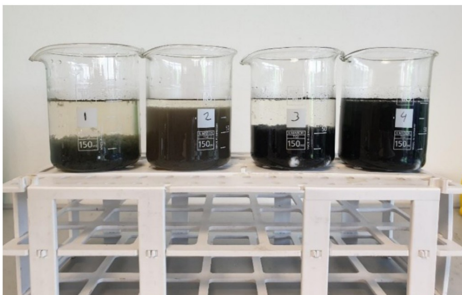
Figuur 2.4 Na toevoegen (4mL 0,1 %) polymeer (Synthofloc EM 8329)
