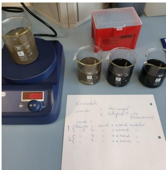
Figuur 2.2 Toevoeging van het vlokmiddel
