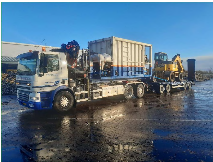
Voorbeeld van bentonietmixer en mobiele kraan.
