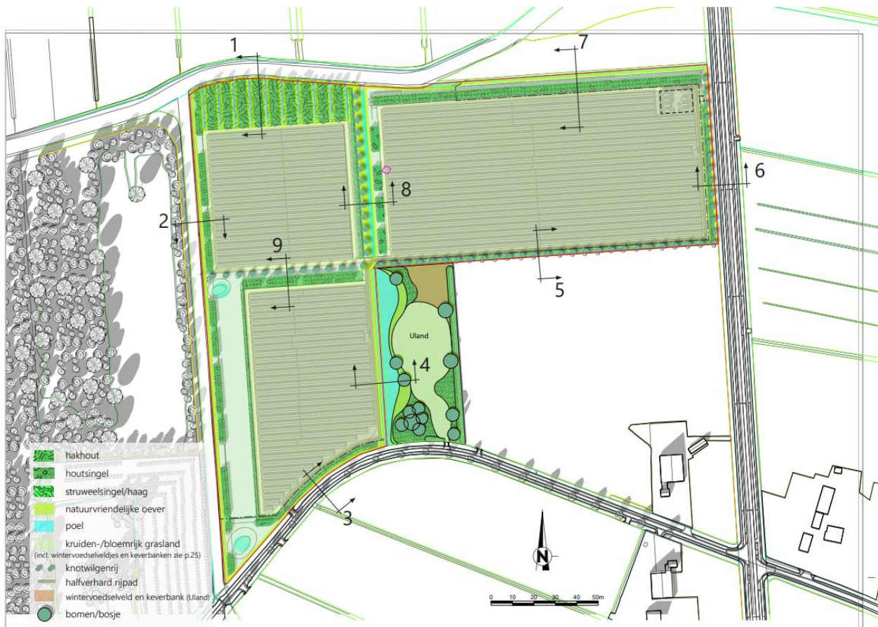
Afbeelding 4. Inrichting van het te ontwikkelen zonnepark en compensatiegebied. De gestreepte donkergroene vlakken geven de locatie van de zonnepaneelvelden weer. Landschappelijke inpassingen zijn in de legenda weergegeven. In de noordoosthoek van het plangebied wordt een energie opslag aangelegd. Overige oppervlaktes worden natuurlijk ingericht.
