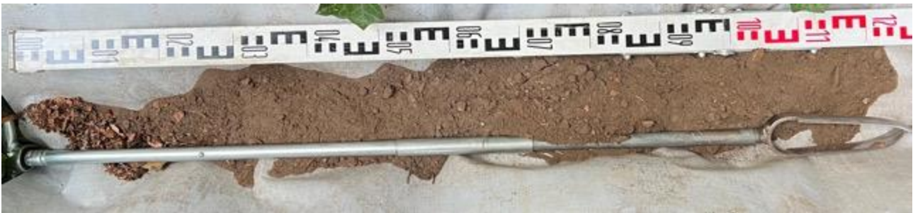
Afbeelding 4: resultaat grondboring
