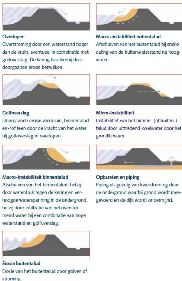
Figuur 158.1: Faalmechanismen waterkeringen (bron: ENW, Grondslagen Hoogwaterbescherming, december 2016)
