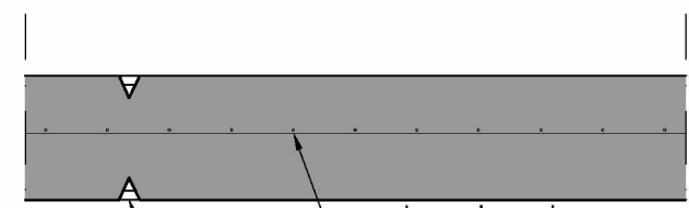
Detail t.p.v. krimpvoeg (ondiepe kelder) (horizontale doorsnede) schaal 1:20 Gestorte buitenputwand iedere 15m1 v.z.v. krimpvoeg
