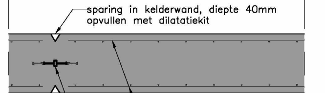
Detail dilatatievoegband (horizontale doorsnede) wapening t.p.v. dilatatievoegband onderbreken
