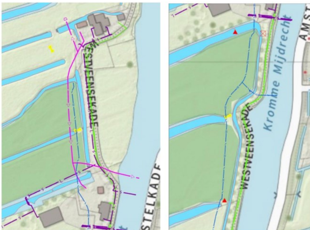
Figuur 2-15 Rioolpersleiding en waterleiding aan oostzijde
