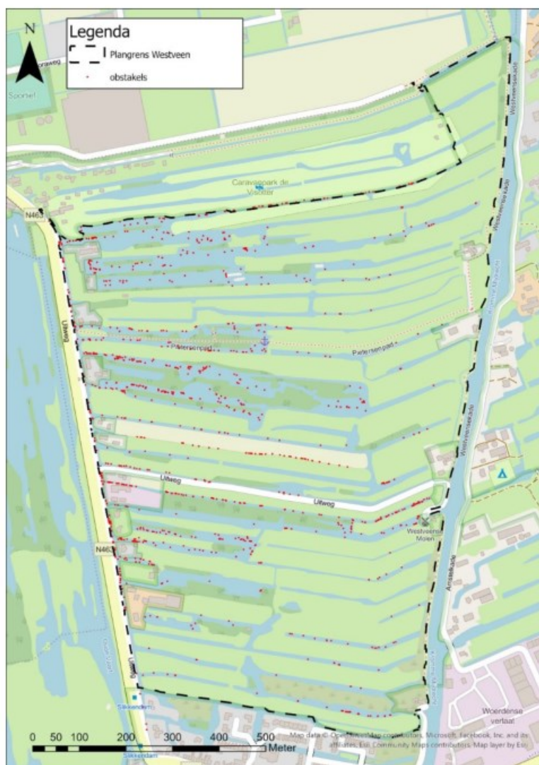
Figuur 6-2 Objecten/obstakels in bagger (Bron: radarmeting ATKB)
