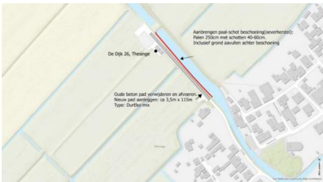
Figuur 1: De rode lijn geeft de locatie van de te plaatsen beschoeiing weer. De grijze lijn geeft het te vervangen toegangspad weer.
