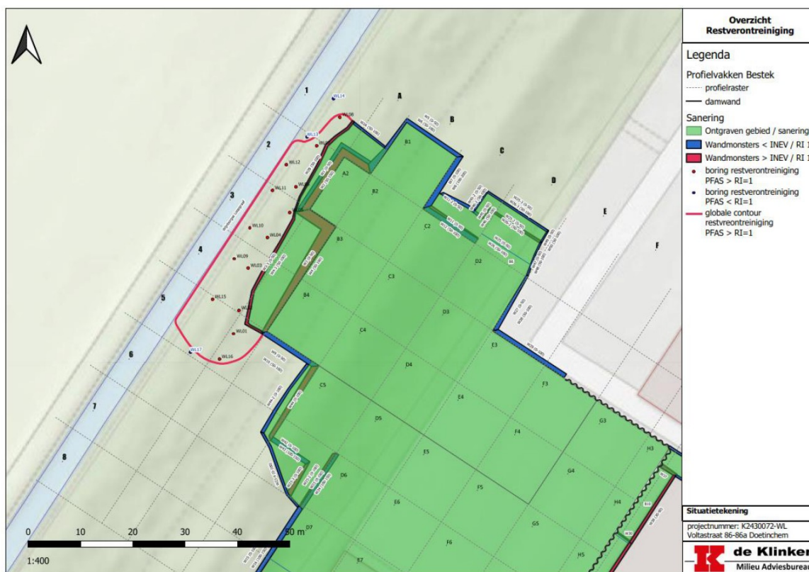
Afbeelding 2.3 Restverontreiniging wandmonsters noordwestzijde ontgraving fase 1 [ref. 22]
