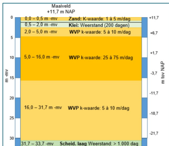
Afbeelding 2.2 Schematische weergave bodemopbouw
