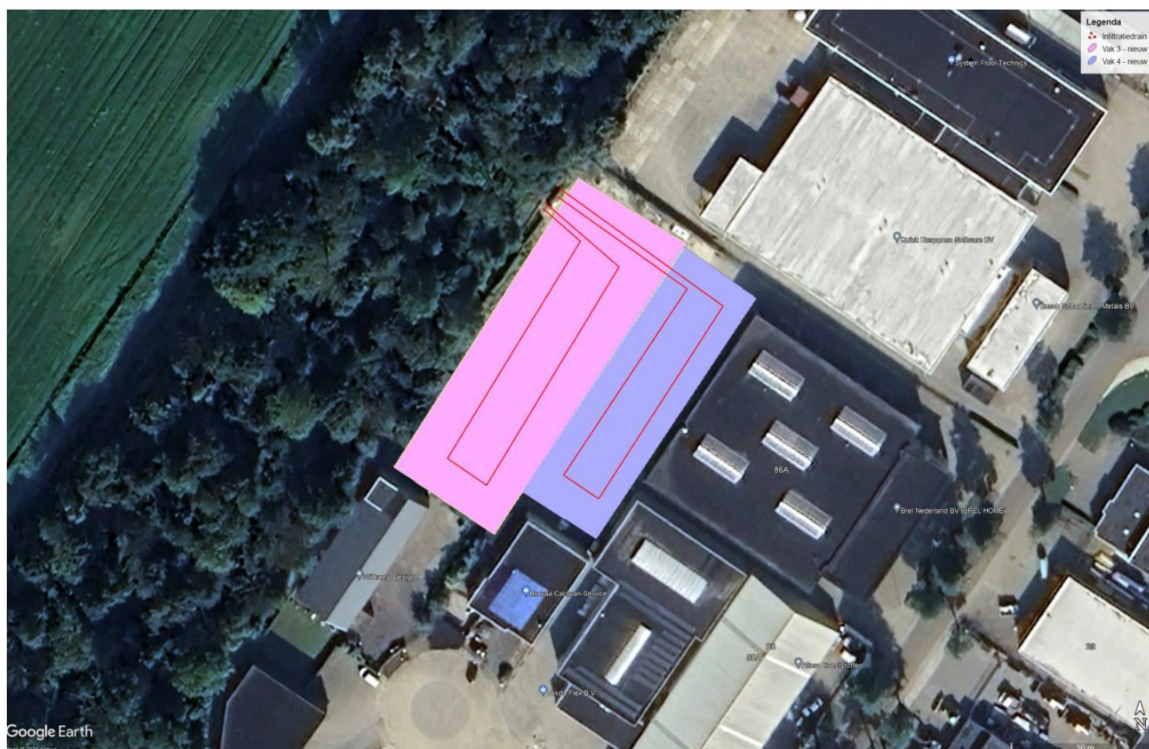
Afbeelding 3.5 Principe infiltratiedrainage
