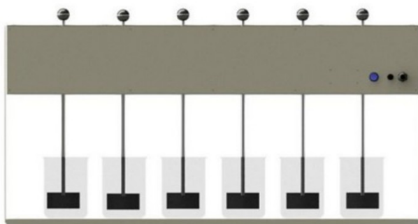
Afbeelding V.1 Opstelling jar-testen
