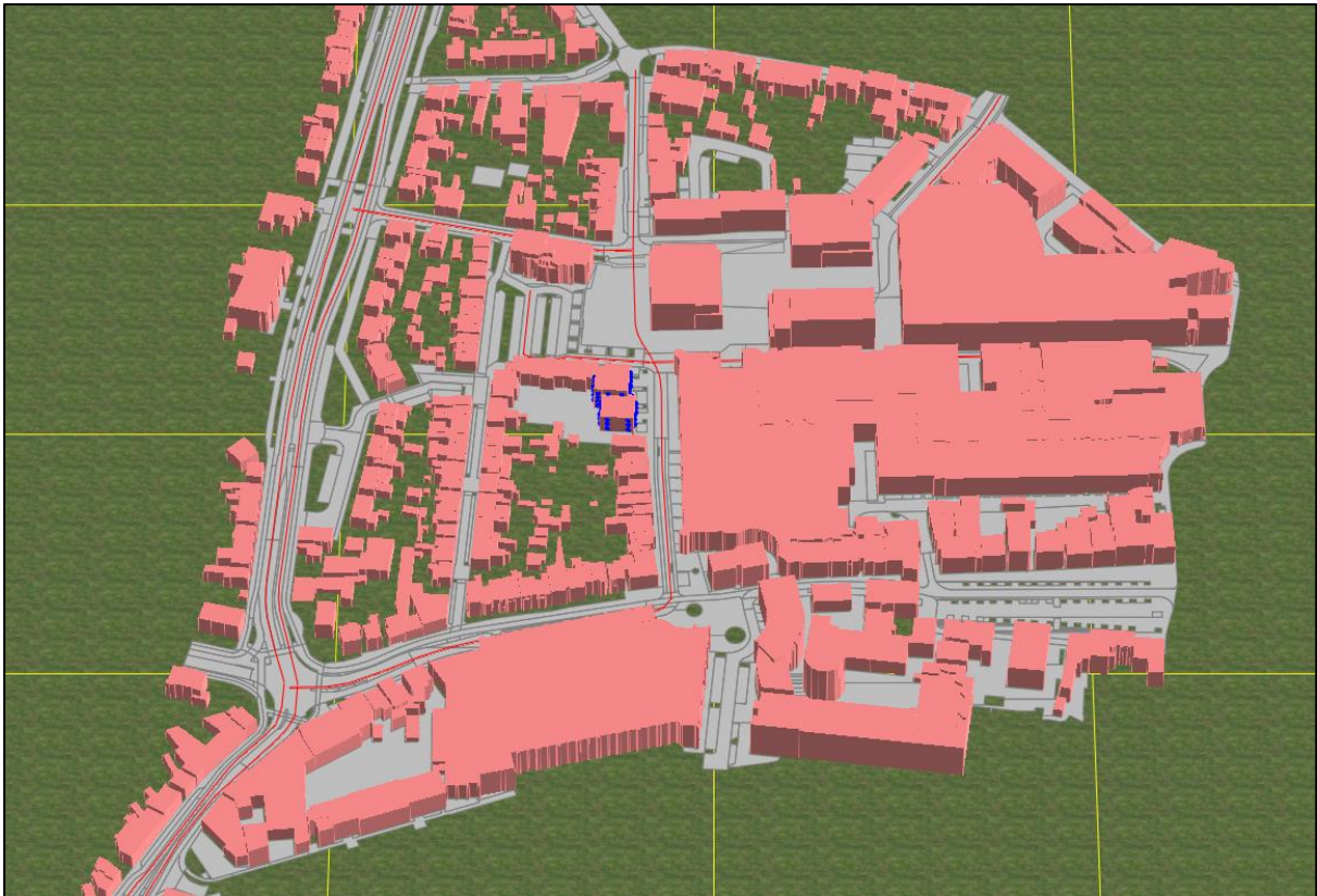
Figuur 4.1: Weergave 3D-omgevingsmodel wegverkeerslawaai
