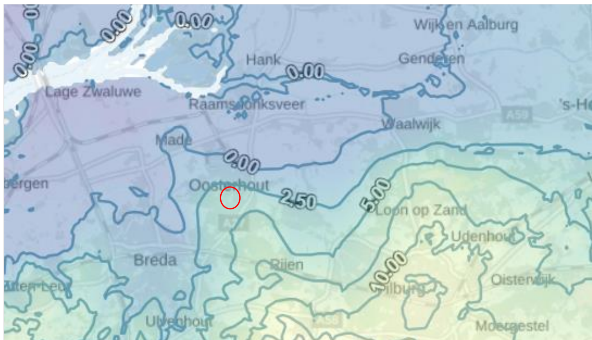
Figuur 2.6. Hoogte en stromingsrichting grondwater (bron: grondwatertools.nl).
