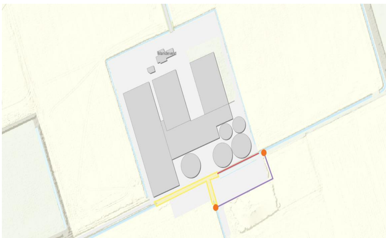
Figuur 1: Locatie van activiteiten. De rode lijn geeft de gedeeltelijk te dempen watergang weer. De paarse lijn geeft de nieuw te graven primaire watergang weer. De oranje cirkels geven de 2 nieuw aan te leggen dammen met duiker weer. In geel gearceerd zijn weergegeven de reeds aangelegde duikers.
