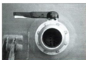
Kunststof vlinderklep met 6" tankwagenkoppeling
