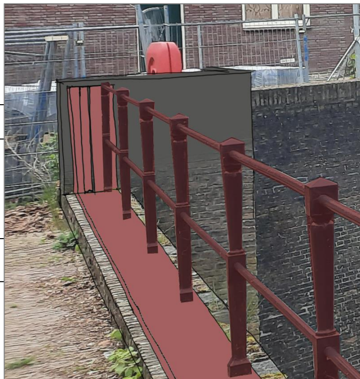
Figuur 7-4 Visualisatie van een mogelijke detailuitwerking van integratie van het hekwerk met de permanente voorzieningen van de demontabele kering, bevestigd op de bestaande vestingmuur (sectie 266-1).
