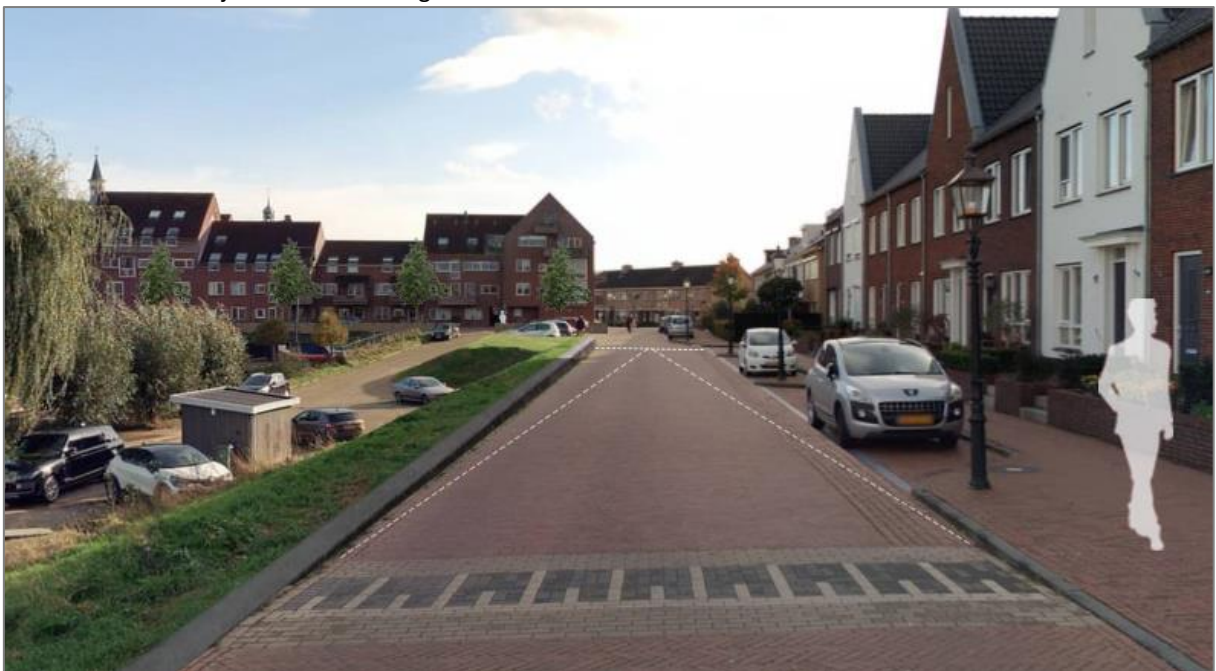
Figuur 7-26 Visualisatie van de betonband die langzaam overloopt in een laag betonnen muurtje
