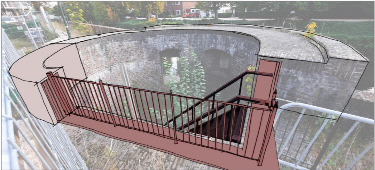
Figuur 7-7 Visualisatie van een mogelijke detailuitwerking van integratie van het hekwerk met de permanente voorzieningen van de demontabele kering, bevestigd op de bestaande vestingmuur (sectie 266-3).
