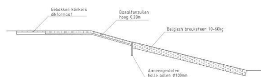
DETAIL F TALUDVOORZIENING schaal 1:100
