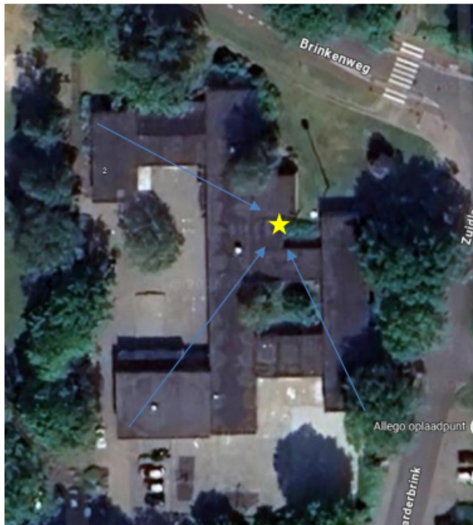
Figuur 4: De richting waarin gewerkt moet worden bij het verwijderen van de fundering (blauwe pijlen). De ster is de locatie van de toegangsopening tot de fundering onder de school die gebruikt wordt door de steenmater
