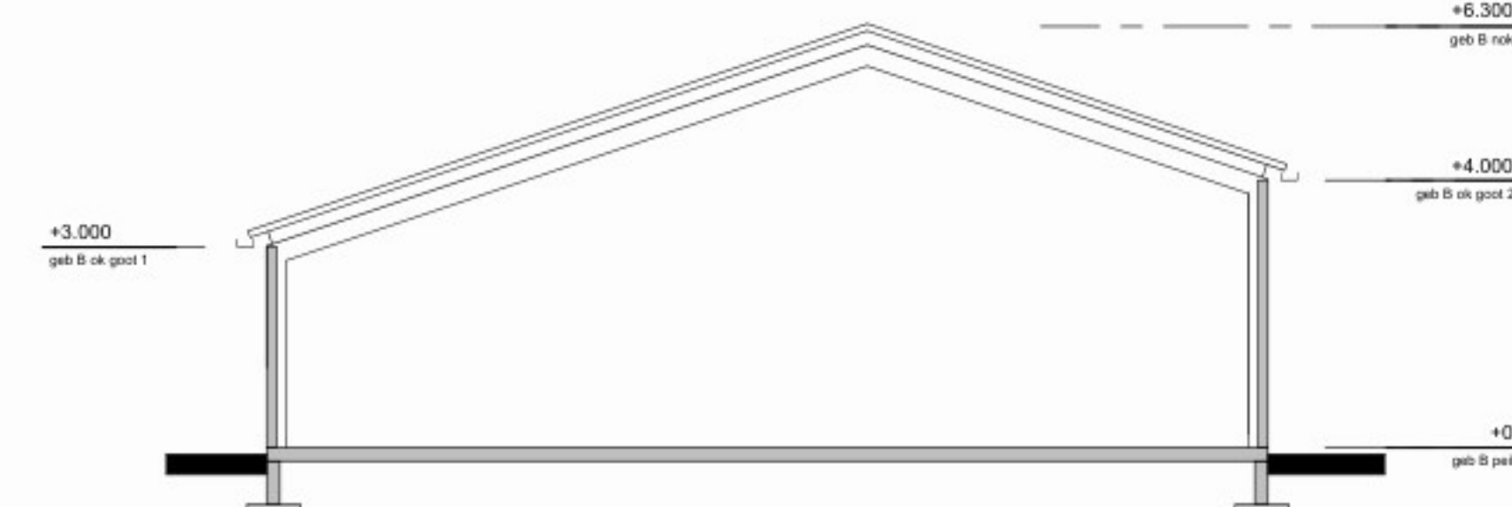
doorsnede B
