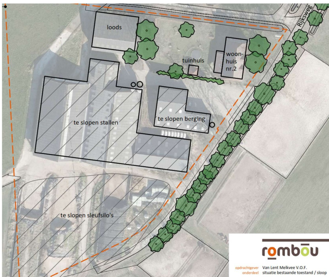
Afbeelding 2: Te slopen stallen, berging en sleufsilos (gearceerd)
