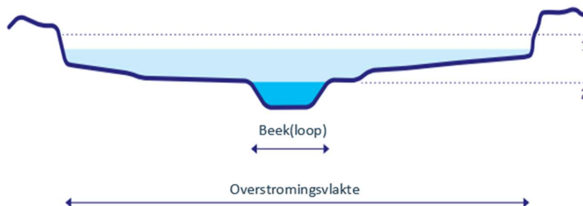
Figuur 5-2 Principeprofiel van een beek met R-type 5. (Handboek geomorfologisch beekherstel, Stowa).
