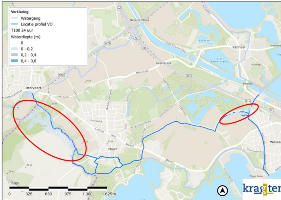
Figuur 5-5 Inundaties bij een T100 24-uurs afvoer voor het VO van de beek
