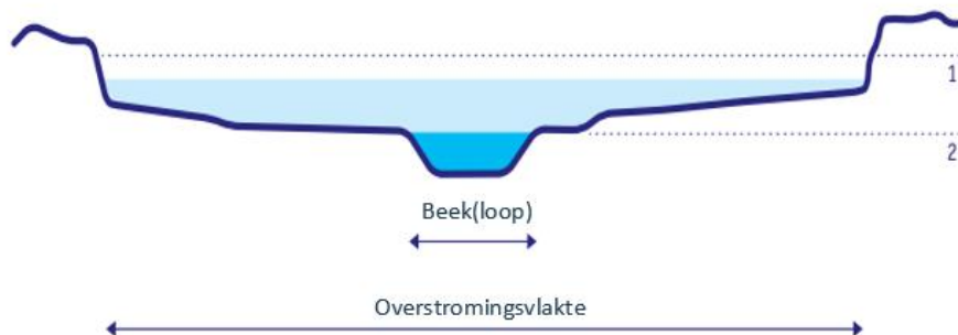
Figuur 0-4: Voorbeeld van een standaard dwarsprofiel van een beek uit het Handboek geomorfologisch beekherstel (Stowa). In het ingepaste ontwerp is de beekloop aan de rand van de overstromingsvlakte gelegd. Zo kan één zijde van de beek ecologisch optimaal worden ingericht en de andere zijde volgens de eisen vanuit beheer en onderhoud.
