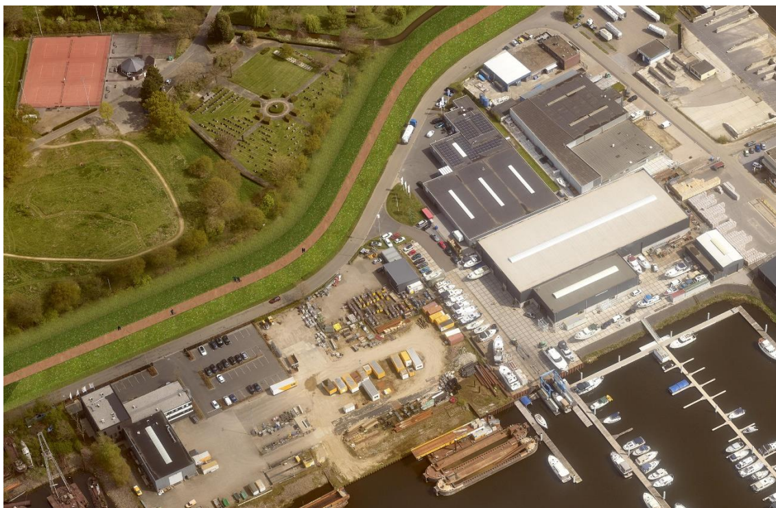
Figuur 6-5 Ontwerpsituatie waarbij de groene kering langs de Waage Naak komt te liggen. De kruin van de dijk is 70 tot 90 cm hoger dan de weg.
