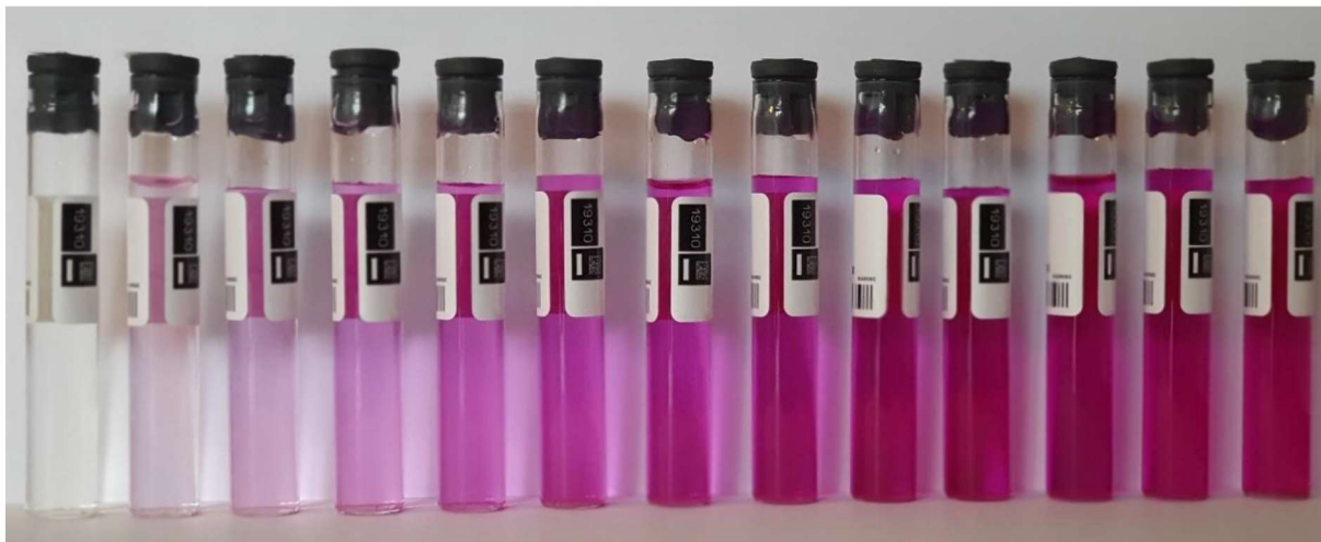
Foto 1. Kuvetten met de chroom 6 kalibratievloeistoffen (v.l.n.r = van lage naar hoge chroom 6 gehalten).
