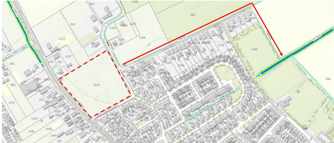
Figuur 12: Schematische afvoerroute van noodoverloop plangebied naar A-watergang
