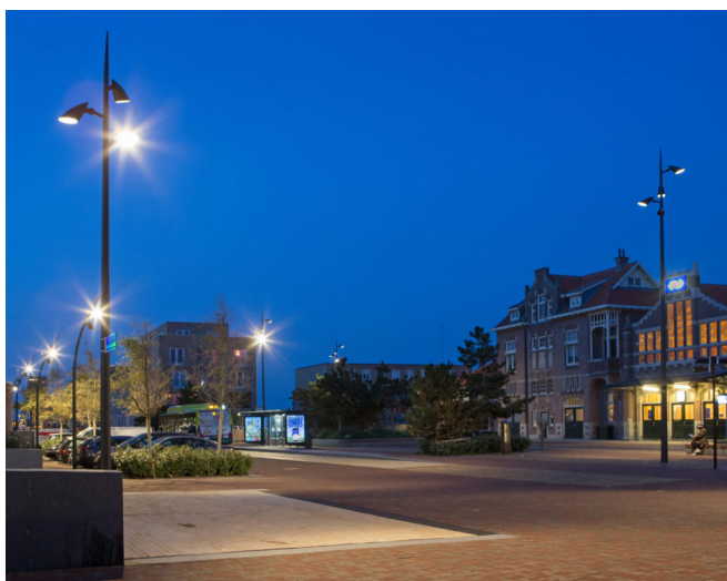
Lichtmasten met richtbare spots op pleinen
