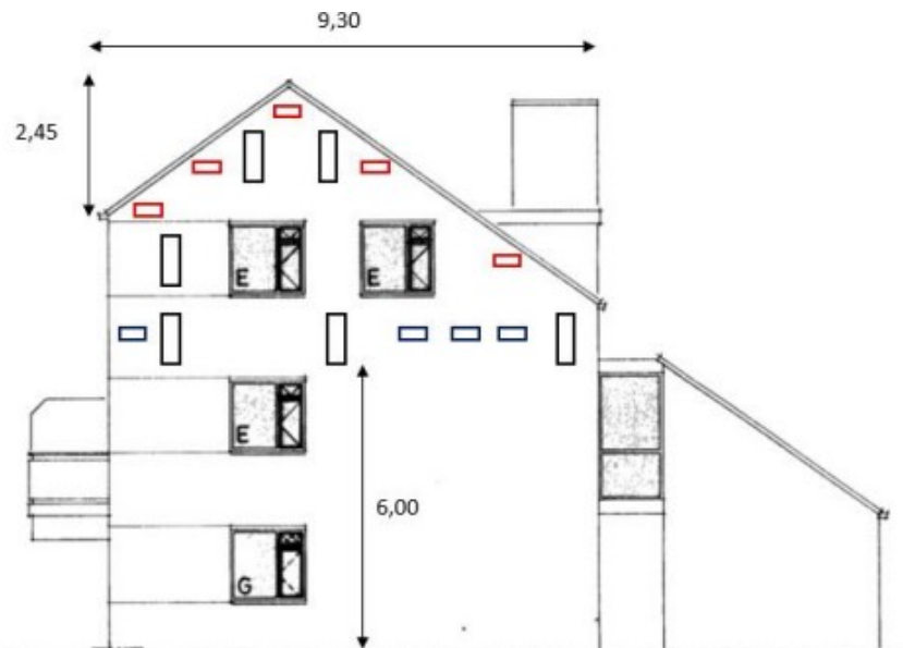
Figuur 5: Voorbeeld van een principe verdeling van de inbouwvoorziening voor gewone dwergvleermuis, huismus en gierzwaluw op een kopgevel.
