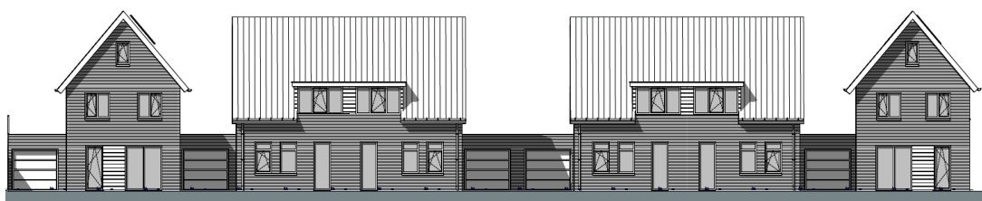
Figuur 1.11 Geveltekening voorzijde 6 geschakelde patiowoningen aan de Baarschotsestraat (Bron: Condor Bouwadvies)
