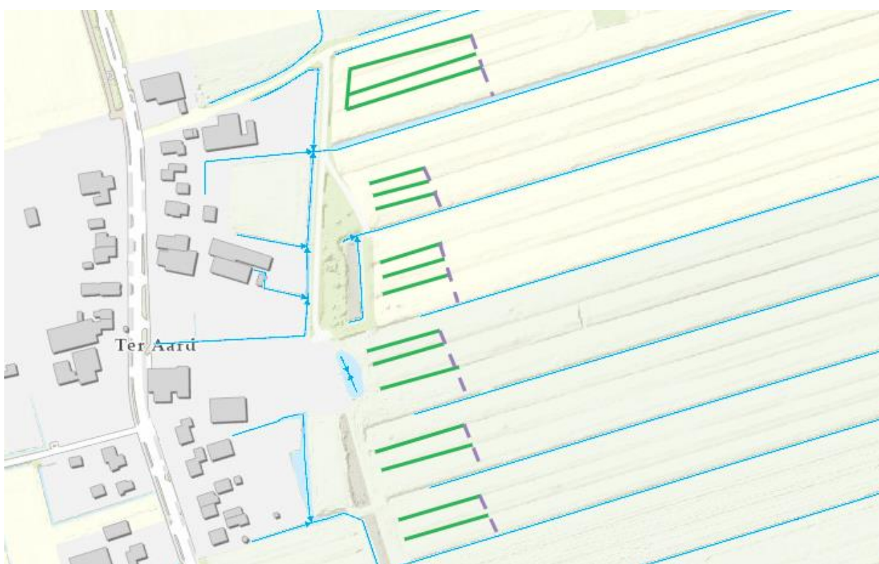
Figuur 1: De groene lijnen geven globaal de locaties weer van het te graven oppervlaktewater. De paarse stippellijn geeft globaal de locaties weer van de te plaatsen duikers. De blauwe lijnen geven de locaties weer van de bestaande secundaire watergangen.
