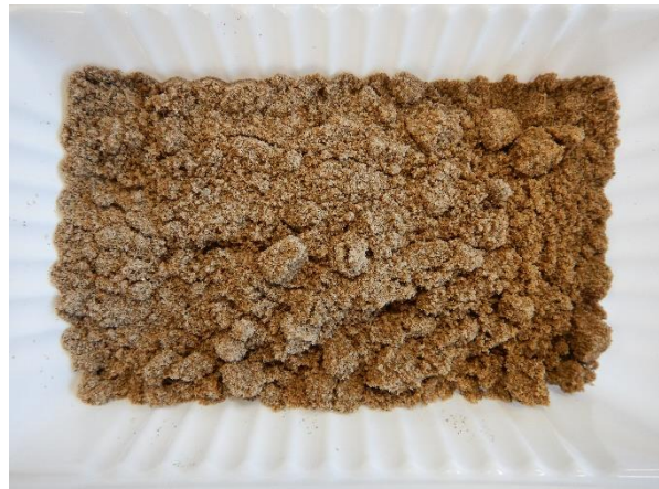
Locatie 1 – Zand (onder vloer) 153,59g
