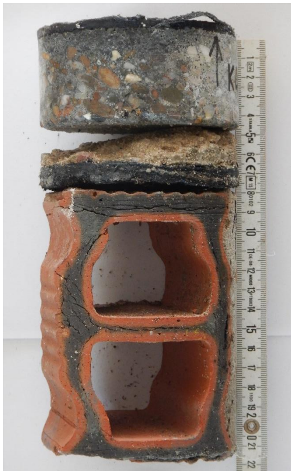
Foto 4.13: Betonkern opbouw systeemvloer.
