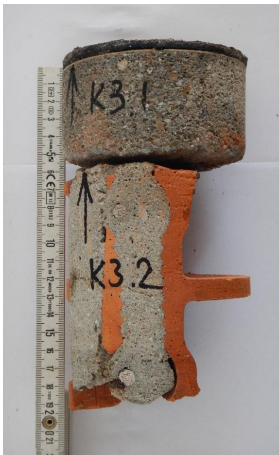
Foto 4.18: Ruimte onder holle baksteenvloer.
