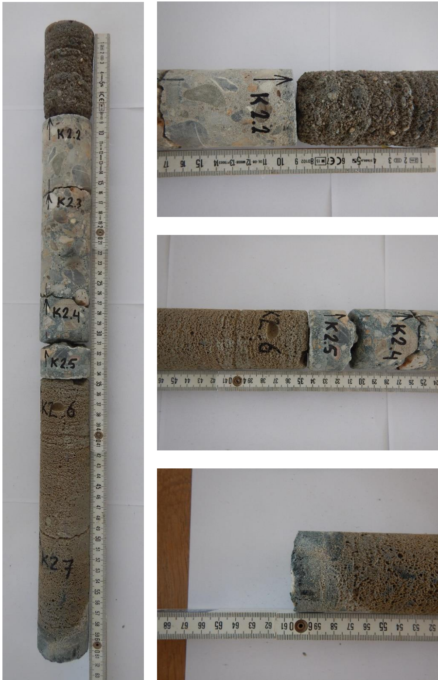
Foto 4.9: Foto's betonkern begane grondvloer boog 96.
