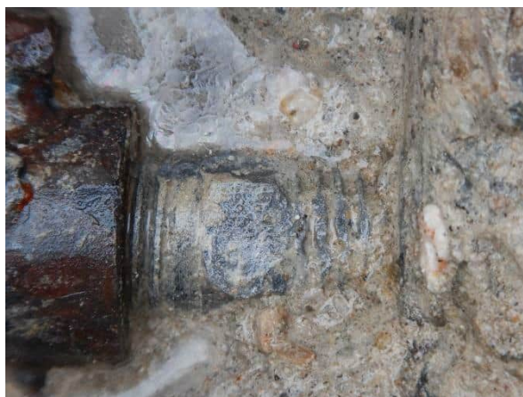
Foto 4.12: Draadeind met zeskant en linkse en rechtse draad.
