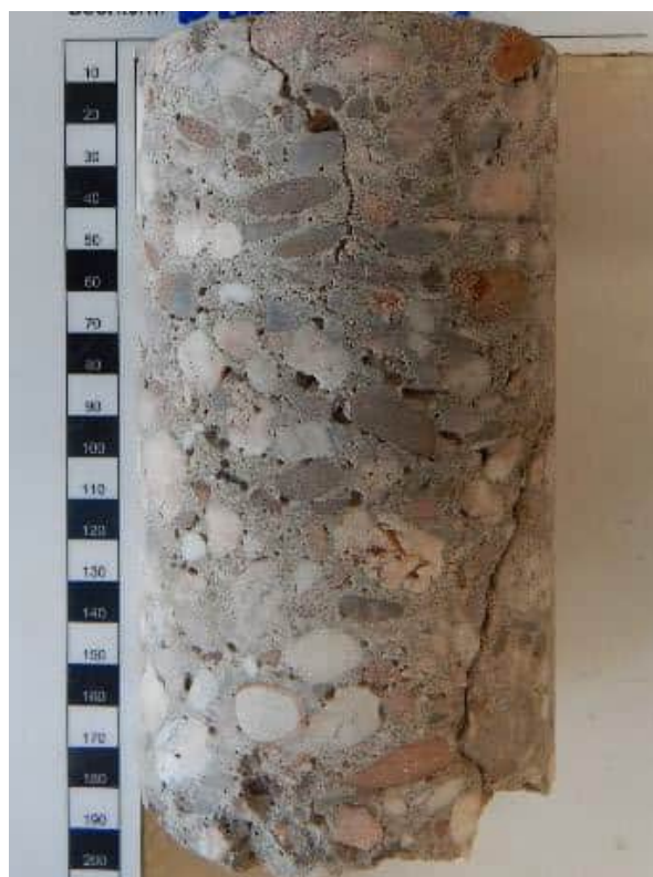
Foto 4.23: Betonkern O22-K3, afkomstig uit bovenzijde getoogde vloer.
