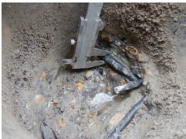
Foto 4.17: Diameter bovenwapening (Ø12 mm).
