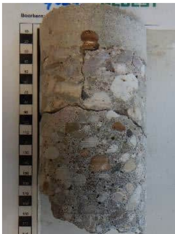
Foto 4.22: Betonkern O21-K2, afkomstig uit onderzijde getoogde vloer.
