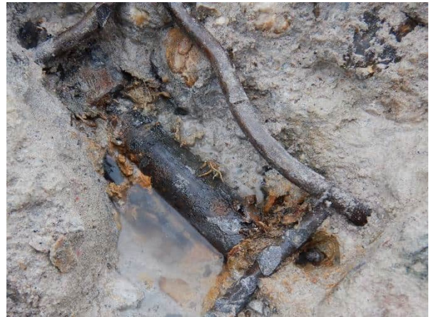
Foto 6.97: Vrijgemaakte wortelconstructie Dywidagstaaf onderzoekslocatie O20-W4.
