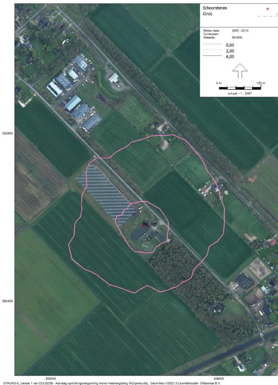
Figuur d Geurcontour van 0,6 \text{ ou}_E/\text{m}^3 als 99,9-percentielwaarde als gevolg van de mono mestvergisting te Wijnjewoude in de aangevraagde situatie.
